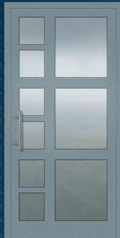
Modell 5501 U_D -Wert = 1,9 W/m^2K^* geteilte Sprossen 45 und 90 mm, Edelstahl-Stoßgriff 5722.350, Wärmeschutzisoliertglas, vorne: VSG beschichtet, hinten: Float, Mastercarre, Chinchilla weiß, Oberfläche: RAL 7001 matt.
