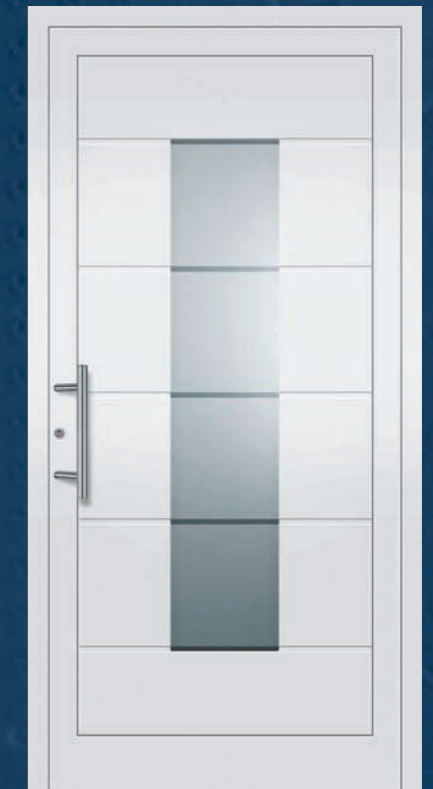
Modell 5326 U_D -Wert = 1,5 W/m^2K^* Edelstahl-Stoßgriff 5722.350, vorne: VSG mattiert mit klaren Streifen, hinten: Float beschichtet, Nuten nur außen.
