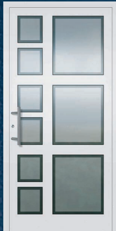
Modell 5512 U_D -Wert = 1,9 W/m^2K^* geteilte Sprosse 45 und 90 mm, Edelstahl-Stoßgriff 5722.350, Verglasung: Wärmeschutzisoliertes Vorne: VSG mattiert mit klarem Rand, hinten: Float beschichtet.
