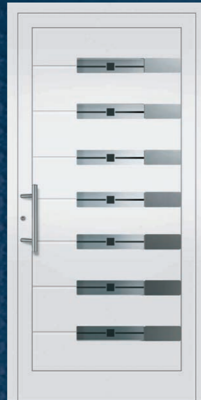
Modell 5308 U_D -Wert = 1,5 W/m^2K^* Edelstahl-Stoßgriff 5722.350, vorne: VSG mattiert mit klaren Streifen und Quadraten, hinten: Float beschichtet, Nuten und Applikationen nur außen.
