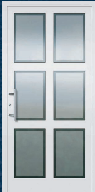
Modell 5511 U_D -Wert = 1,9 W/m^2K^* geteilte Sprosse 90 mm, Edelstahl-Stoßgriff 5722.350, Verglasung: Wärmeschutzisoliertes Vorne: VSG mattiert mit klarem Rand, hinten: Float beschichtet.
