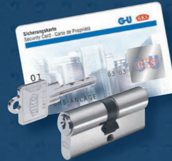
Anbohrgeschützter Sicherheitszylinder * mit Not- und Gefahrenfunktion, mit 8 Wendschlüsseln und Sicherungskarte gemäß DIN EN 1303
