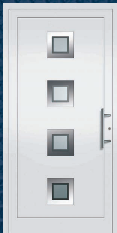
Modell 5206 U_D -Wert = 1,4 W/m^2K^* Edelstahl-Stoßgriff 5722.350, vorne: VSG mattiert mit klarem Rand, hinten: Float beschichtet alternativ vorne: VSG beschichtet, hinten: Float, Chinchilla weiß oder Mastercarre weiß.
