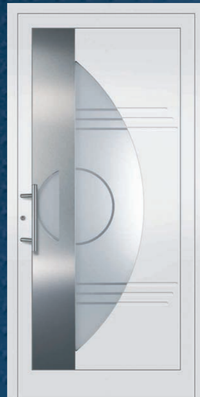
Modell 5316 U_D -Wert = 1,5 W/m^2K^* Edelstahl-Stoßgriff 5722.350, vorne: VSG mattiert mit klaren Streifen, hinten: Float beschichtet, Nuten und Applikation nur außen.
