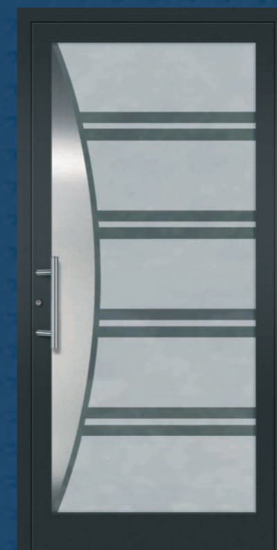
Modell 5456 U_D -Wert = 1,7 W/m^2K^* Edelstahl-Stoßgriff 5722.350, Verglasung: Wärmeschutzisolierverglasung, vorne: VSG, Mitte: ESG mattiert mit klarem Motiven und Alu-Nox-Applikationen, hinten: Float beschichtet. Oberfläche: RAL 7016 matt.
