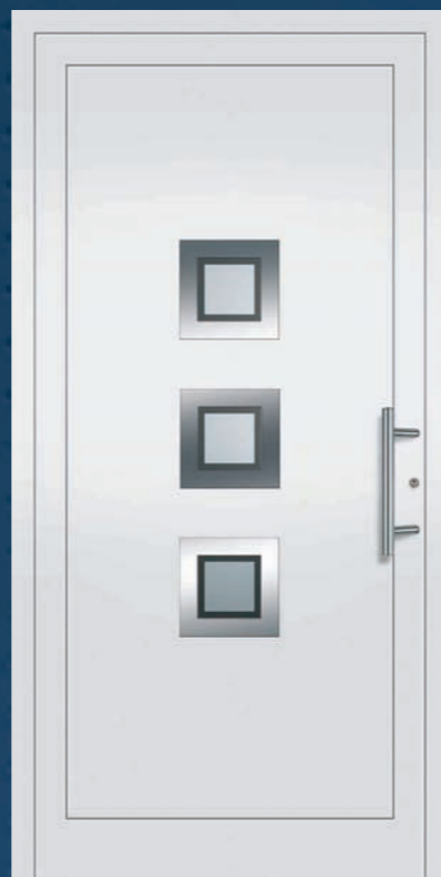
Modell 5202 U_D -Wert = 1,3 W/m^2K^* Edelstahl-Stoßgriff 5722.350, vorne: VSG mattiert mit klarem Rand, hinten: Float beschichtet alternativ vorne: VSG beschichtet, hinten: Float, Chinchilla weiß oder Mastercarre weiß.
