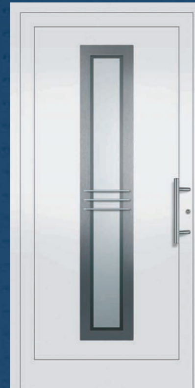
Modell 5223 U_D -Wert = 1,4 W/m^2K^* Edelstahl-Stoßgriff 5722.350, vorne: VSG mattiert mit umlaufend klarem Rand, hinten: Float beschichtet, außen: drei Edelstahlbügel auf breitem Rahmen montiert.
