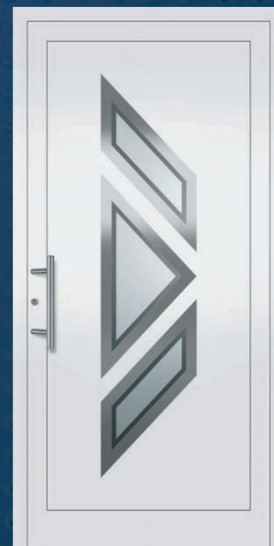
Modell 5210 U_D -Wert = 1,5 W/m^2K^* Edelstahl-Stoßgriff 5722.350, vorne: VSG mattiert mit umlaufend klarem Rand, hinten: Float beschichtet alternativ vorne: VSG beschichtet, hinten: Float, Chinchilla weiß oder Mastercarre weiß.
