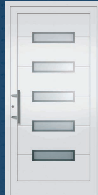
Modell 5321 U_D -Wert = 1,5 W/m^2K^* Edelstahl-Stoßgriff 5722.350, vorne: VSG mattiert mit umlaufend klarem Rand, hinten: Float beschichtet, Nuten nur außen.
