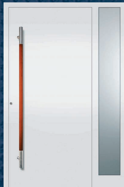
Modell 5415 U_D -Wert = 1,2 W/m^2K^* Anwendungsbeispiel in flügelüberdeckend, Edelstahl-Stoßgriff 5813 mit Echtholz Jatoba auf Füllung montiert, komplett geschlossen, Seitenteil: vorne: VSG komplett mattiert, hinten: Float beschichtet.
