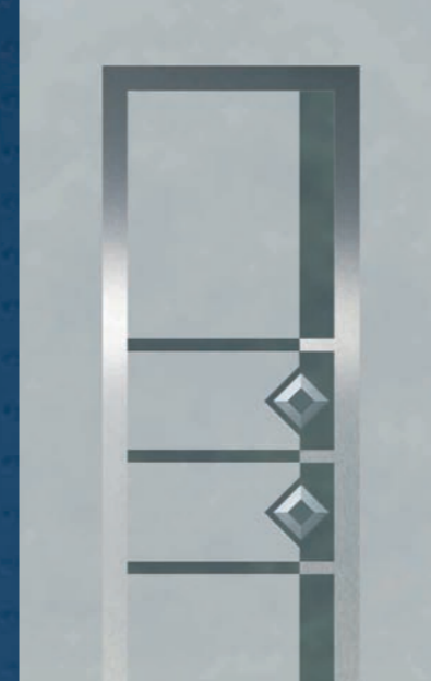
Ganzglasfüllungen Wärmeschutzisolierverglasung bestehend aus: außen: VSG 6 mm Mitte: ESG 4 mm mit Motiv und Alunox innen: Float 4 mm beschichtet
