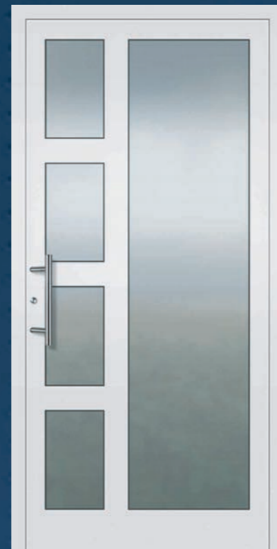
Modell 5502 U_D -Wert = 1,9 W/m^2K^* geteilte Sprossen 90 mm, Edelstahl-Stoßgriff 5722.350, Wärmeschutzisoliertglas, vorne: VSG beschichtet, hinten: Float, Mastercarre, Chinchilla weiß.
