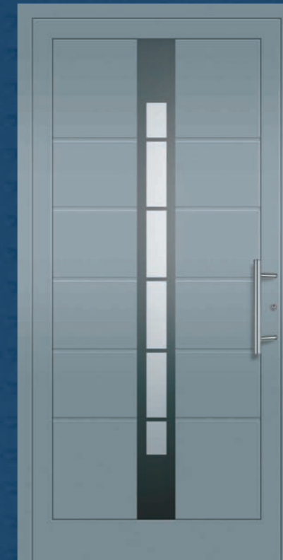
Modell 5322 U_D -Wert = 1,4 W/m^2K^* Edelstahl-Stoßgriff 5722.350, Iso-Verglasung plan, vorne: VSG mattiert mit klaren Streifen, hinten: Float beschichtet, Nuten und Applikationen nur außen. Oberfläche: RAL 7001 matt.
