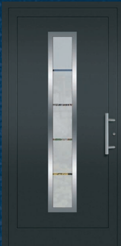
Modell 5212 U_D -Wert = 1,4 W/m^2K^* Edelstahl-Stoßgriff 5722.350, vorne: VSG mattiert mit klaren Streifen, hinten: Float beschichtet. Oberfläche: RAL 7016 matt.
