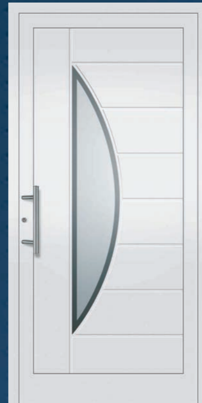
Modell 5324 U_D -Wert = 1,5 W/m^2K^* Edelstahl-Stoßgriff 5722.350, vorne: VSG mattiert mit umlaufend klarem Rand, hinten: Float beschichtet, Nuten nur außen.
