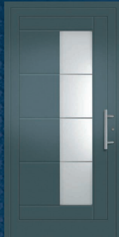
Modell 5314 U_D -Wert = 1,5 W/m^2K^* Edelstahl-Stoßgriff 5722.350, vorne: VSG mattiert mit klaren Streifen, hinten: Float beschichtet, Nuten nur außen. Oberfläche: RAL 7011 matt.
